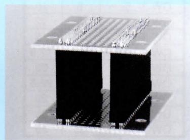
H寸法はPMW-61を使用した場合の親基板と子基板の間隔です。
